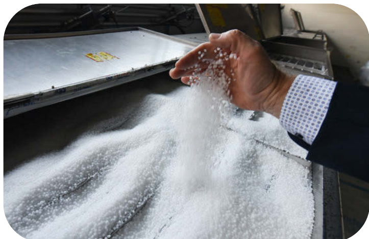
Tworzywo sztuczne tuż przed trafieniem do systemu centralnego zasilania maszyn
